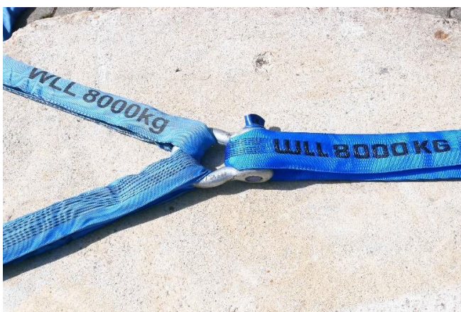
13.1.3-3 Zusammenführen von Rundschlingen mit geschweiftem Schäkel
