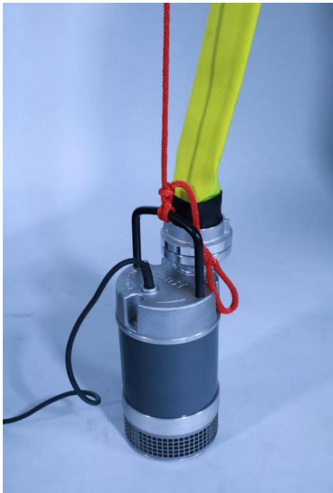
6.6-1 Sicherung mit einem gesicherten Mastwurf
