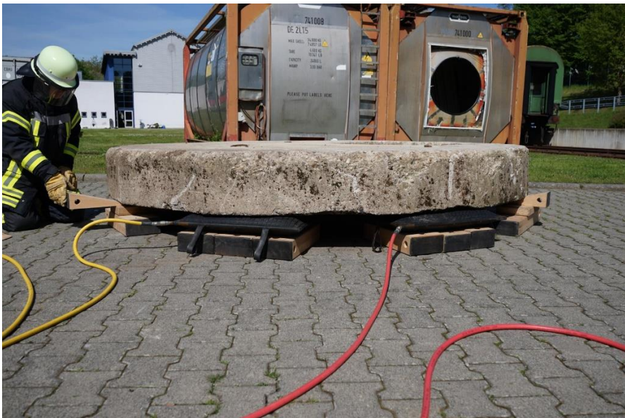
12.1.2-4 Hebekissensystem über 1 bar beim Heben einer Last - nebeneinander angeordnet
