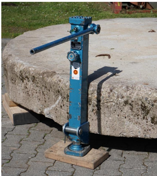
12.2-2 Hydraulische Winde beim Anheben einer Last
