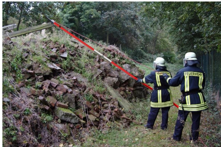
8.9-2 Einreißhaken mit Mehrzweckleine
