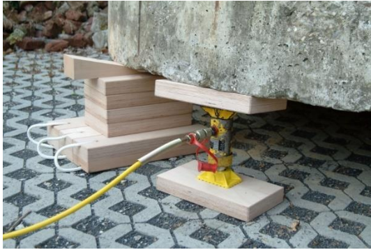
12.3-2 Hydraulischer Hebesatz beim Heben einer Last
