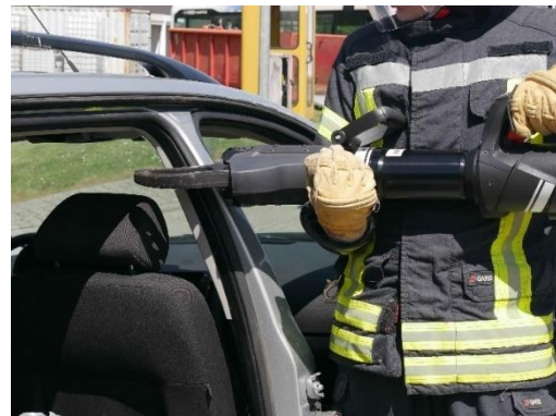
14.2-2 hydraulisches Schneidgerät beim Trennen einer Fahrzeugsäule
