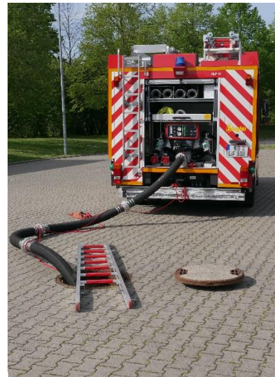
6.3-4 Möglichkeit der Sicherung des Saugschachtes gegen die Gefahr des Absturzes
