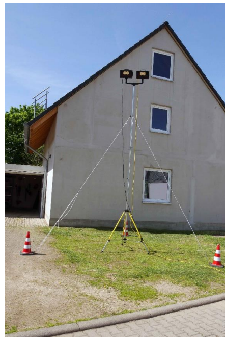
10.4-4 Flutlichtstrahler LED auf Stativ ausgezogen
