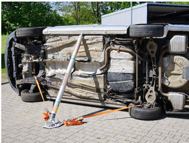
16.3-1 beispielhaftes Abstützen mit Abstützsystem
