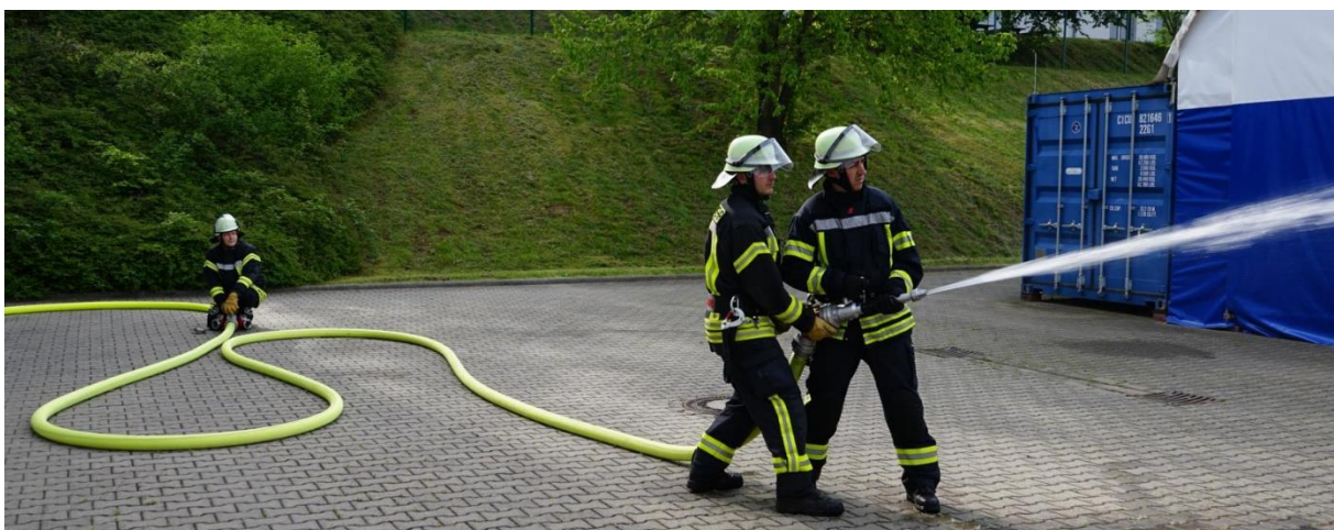
5.2.2-1 Einsatz eines Trupps mit B-Mehrzweck-Strahlrohr (BM) und Stützkrümmer
