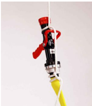
17.3-4 Aufziehen eines Hohlstrahlrohres mittels doppeltem Ankerstich und Halbschlag
