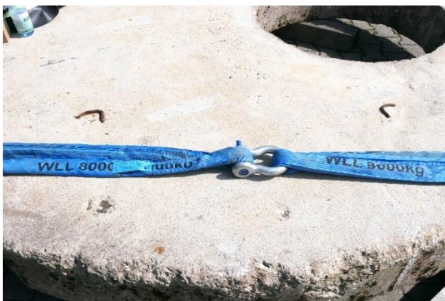
13.1.3-2 Verbinden von Rundschlingen mit einem geschweiften Schäkel
