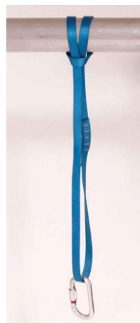
17.2.1-3 doppelter Ankerstich mit einer Bandschlinge
