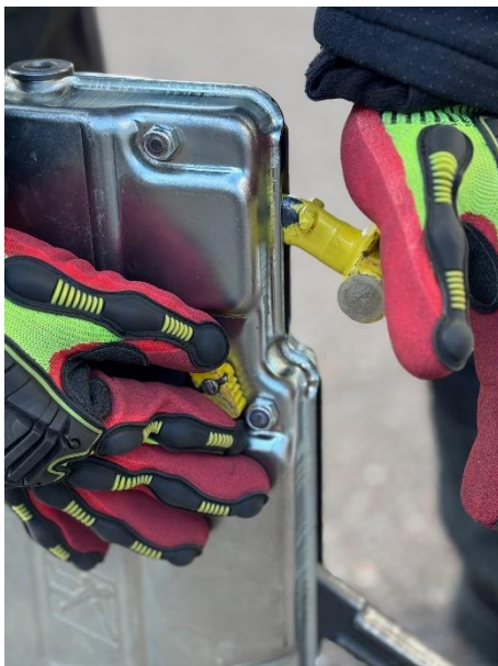
13.2-6 Öffnen der Klemmbackenpaare
