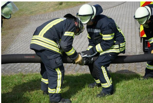
6.1-3 Vorkuppeln der Saugschläuche
