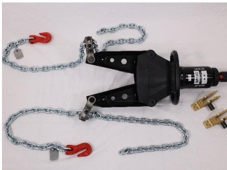
14.1-1 Hydraulischer Spreizer mit eingehängtem Kettensatz
