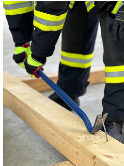
8.3-2 Ziehen von Nägeln mit dem Nageleisen
