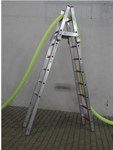
4.4.1-3 Einsatz der Steckleiter als Bockleiter mit Verbindungsteil zur Schlauchüberführung
