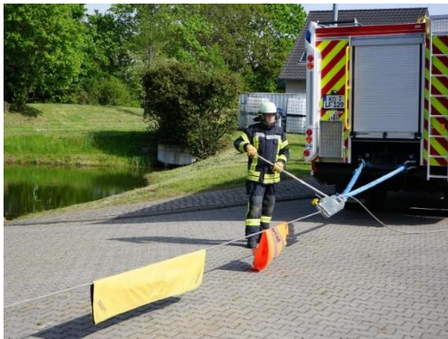
13.2-10 Zugstrecke beispielhaft mit Decke beschwert und mit Warnweste kenntlich gemacht
