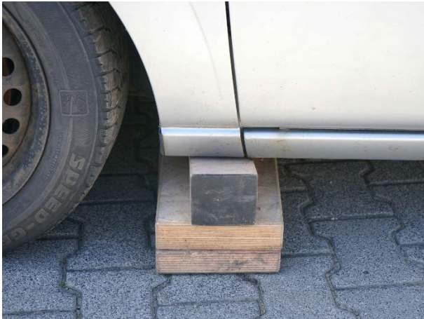
16.2-1 Unterbau aus Holz
