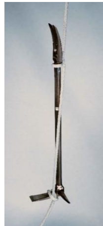
17.3-3 Aufziehen eines multifunktionalen Hebel-Brechwerkzeuges
