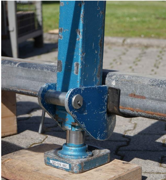
12.2-3 Hydraulische Winde mit rutschhemmender Unterlage an der Hebeklaue
