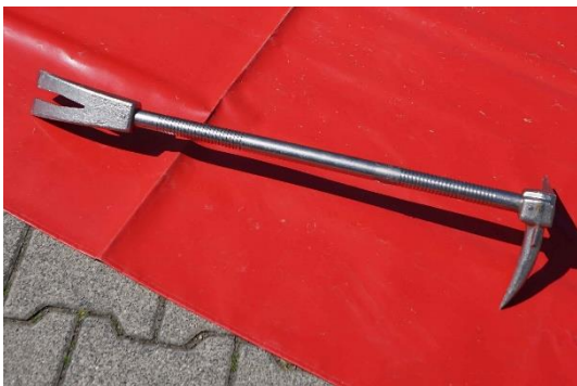
8.2-5 richtig abgelegtes multifunktionales Hebel-Brechwerkzeug
