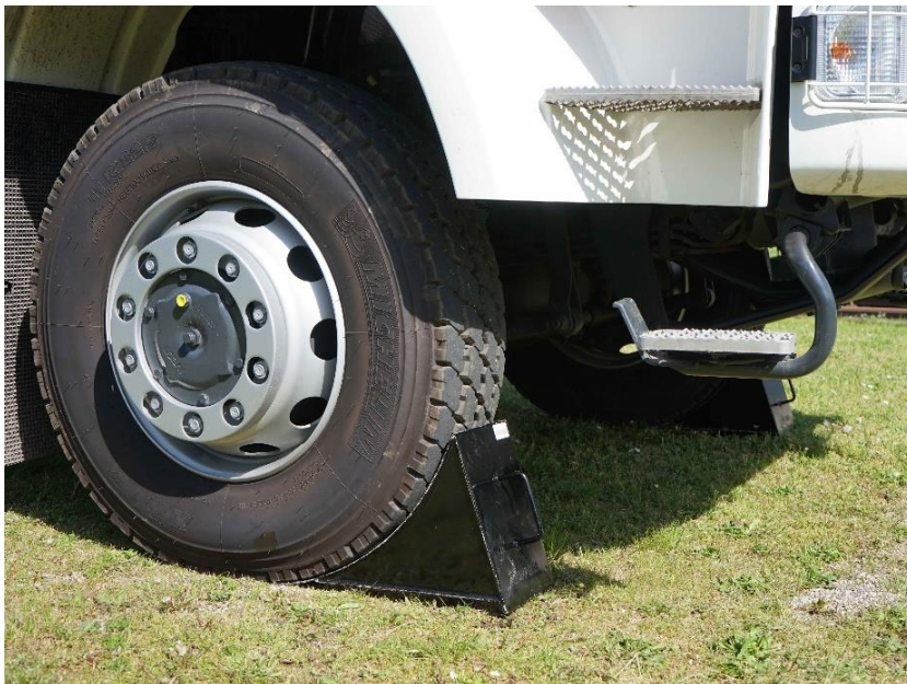
13.3-1 Auffahrkeile auf verdichtetem Untergrund
