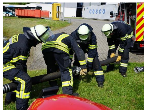
6.1-4 Durchkuppeln der Saugschläuche
