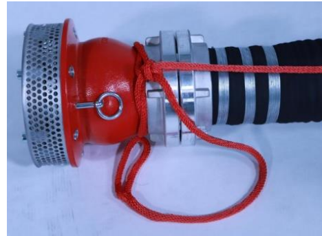
6.1-6 Sicherung des Saugkorbes mittels gesicherten Mastwurfes
