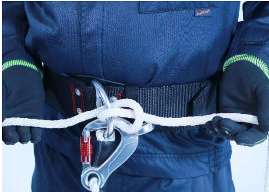
17.2.2-3 Halbmastwurfsicherung in Halteöse des Feuerwehr- Haltegurtes eingelegt
