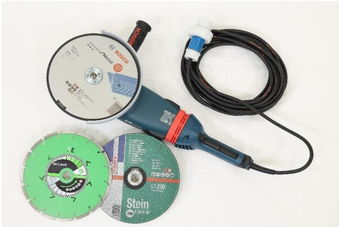
15.5-1 elektrische Trennschleifmaschine mit verschiedenen Trennscheiben
