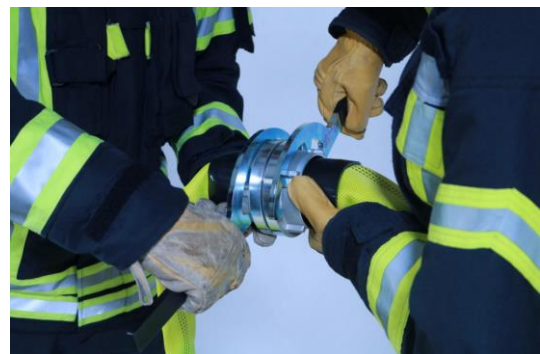
4.3-2 Kuppeln der Schlauchkupplungen mit Kupplungsschlüsseln
