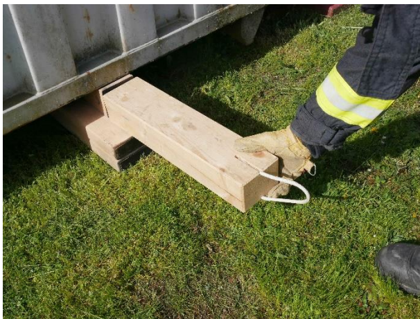
16.1-1 Unterbau aus Holz
